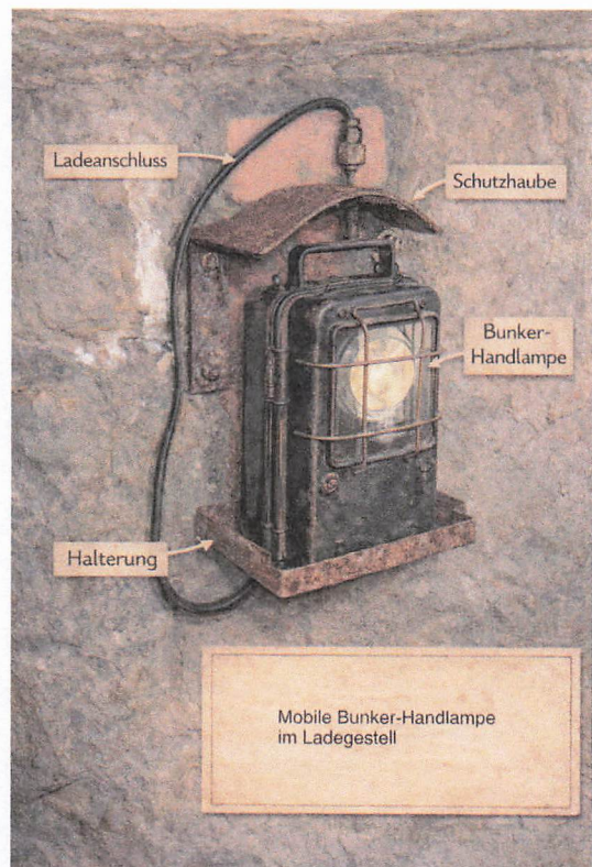
Bunker-Handlampe im Ladegestell
